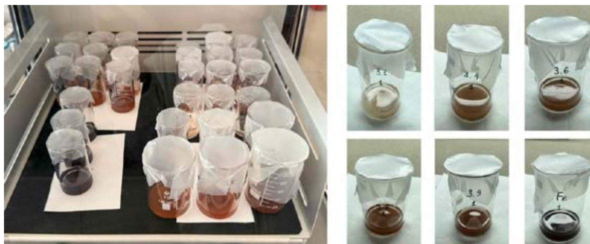
Рисунок 1. (а) Схематичное представление основных этапов синтеза; (б) Эксперименты на оценку коррозионной стойкости (1-x)Fe_3O_4 - xZnO нанокompозитов в модельном буферном растворе
