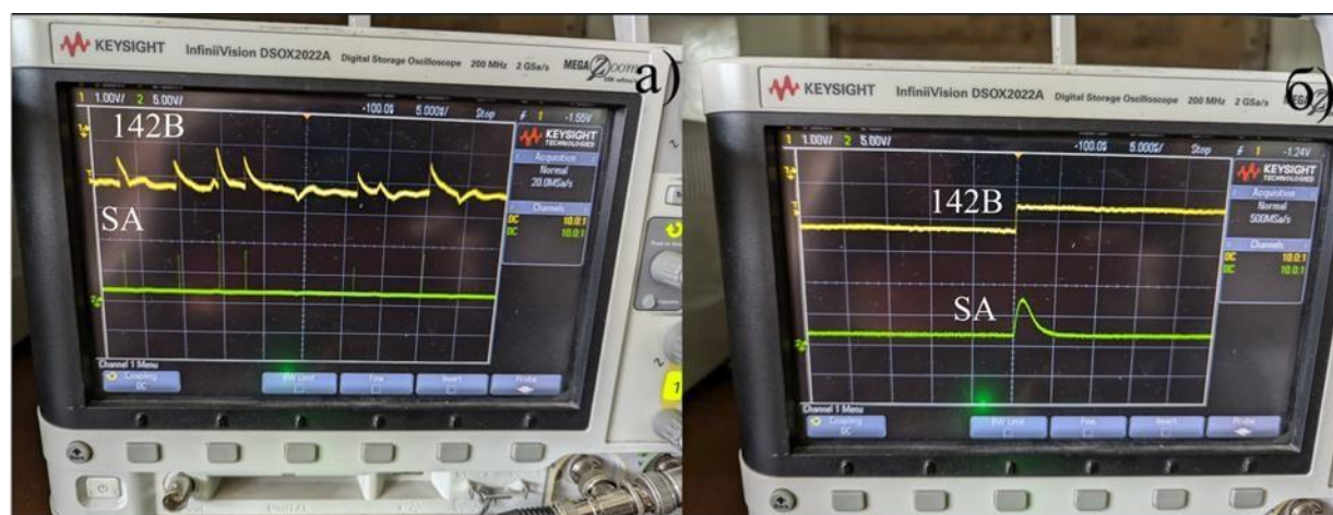
Рисунок 6. Сигналы, полученные на измерительном стенде: а) сигналы с предусилителя 142В и с выхода прототипа SA, б) те же сигналы, но в другом масштабе времени
