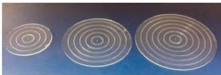
Сурет 1. Концентрлік шеңберлері мен радиустары (солдан оңға қарай) ойылған CR-39 детекторлары R_1 = 2 см, R_2 = 3 см және R_3 = 3,5 см сәйкесінше 1, 2 және 3 диффузиялық камераларға орналастырылған
