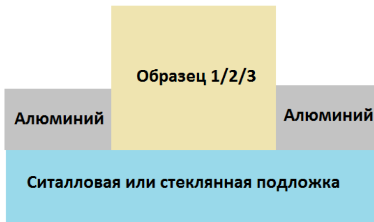
Рисунок 1. Структура тонкопленочного резистивного датчика.
