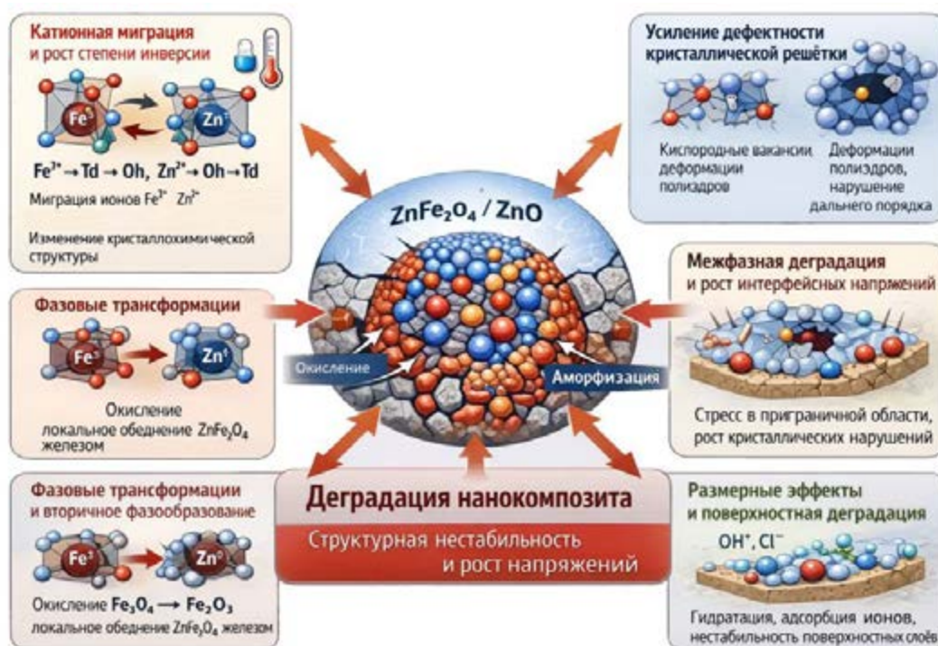
Рисунок 6. Основные механизмы коррозии в (1-x)\text{Fe}_3\text{O}_4 - x\text{ZnO} нанокompозитах
