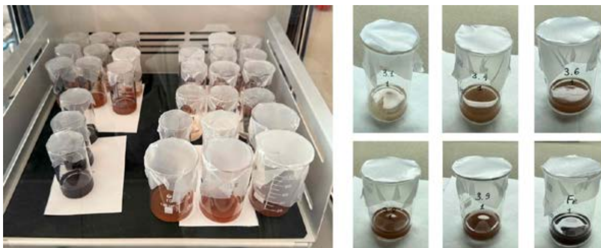
Рисунок 1. (а) Схематичное представление основных этапов синтеза; (б) Эксперименты на оценку коррозионной стойкости (1-x)\text{Fe}_3\text{O}_4 - x\text{ZnO} нанокompозитов в модельном буферном растворе
