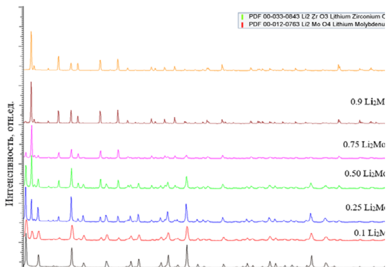
Рисунок 3. Результаты рентгеновской дифракции исследуемых \text{Li}_2\text{ZrO}_3 - \text{Li}_2\text{MoO}_4 керамик
