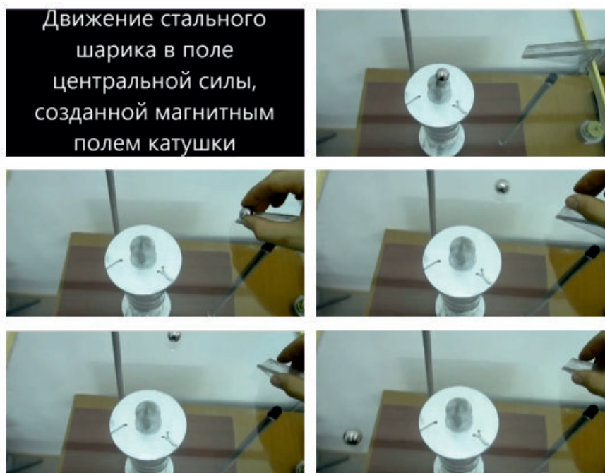
Рисунок 6 – Фрагменты движения шарика в поле центральной силы, созданной магнитным полем катушки
